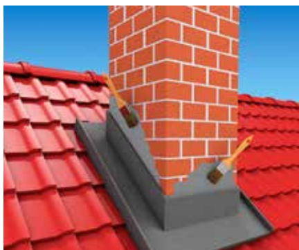
Kémények szigetelése és lezárása
