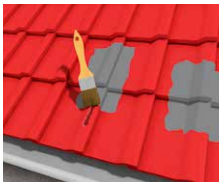
Tetőcserepek szigetelése és javítása
