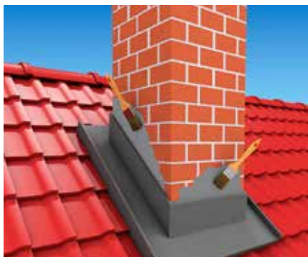
Kémények szigetelése és lezárása
