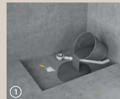
II. Burkolható zuhanytálca beépítése kötőanyaggal kialakított alapra
