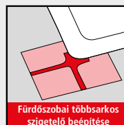
Fürdőszobai többsarkos szigetelő beépítése
