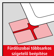
Fürdőszobai többsarkos szigetelő beépítése
